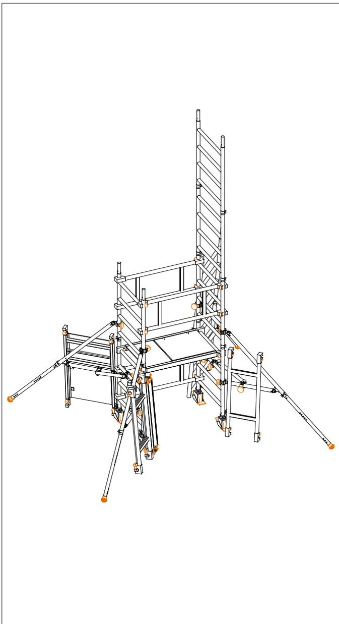
8. Ajustar la barandilla doble **2** como refuerzo entre los travesaños quinto y séptimo por encima de la altura de la plataforma actual y fijarla correctamente en su lugar con las garras de encaje.
