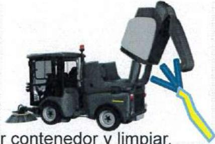
Abrir contenedor y limpiar, limpiar radiador y manguera agua reciclada.
