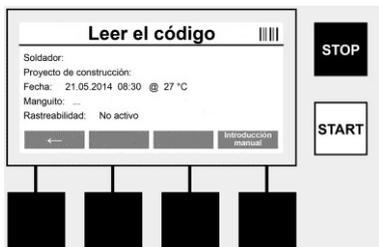
Escanee el código del manguito con ayuda de un escáner de código de barras. Si el escáner de código de barras está estropeado o no se puede leer el código del manguito, el código del manguito también se puede introducir manualmente. Para ello pulse la tecla >INTRODUCCIÓN MANUAL< (véase también la sección "Introducción").
