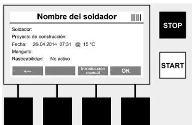
En la opción de menú **>SOLDADURA<** se pueden introducir los datos necesarios para la soldadura. Para ello se puede escanear un código de barras con el escáner de código de barras, u opcionalmente también manualmente con las teclas multifunción.
