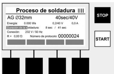
Durante el proceso de soldadura se muestran todos los datos relevantes en la pantalla. El proceso de soldadura se supervisa durante todo el tiempo de soldadura según los parámetros de soldadura indicados mediante el código del manguito.
