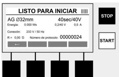
Diámetro ..... El diámetro del tubo conforme al código del manguito
