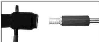
Coloque manualmente el nuevo adaptador, enrésquelo hasta el tope y con el destornillador Torx 15 atornillelo firmemente (15 Nm); a continuación, retire el pasador de fijación.
