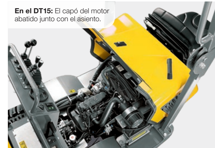
Gracias a las tapas desmontables para el mantenimiento, se puede acceder fácilmente a todos los componentes principales.
