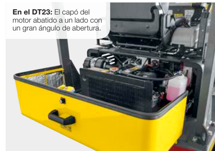
Gracias a las tapas desmontables para el mantenimiento, se puede acceder fácilmente a todos los componentes principales.
